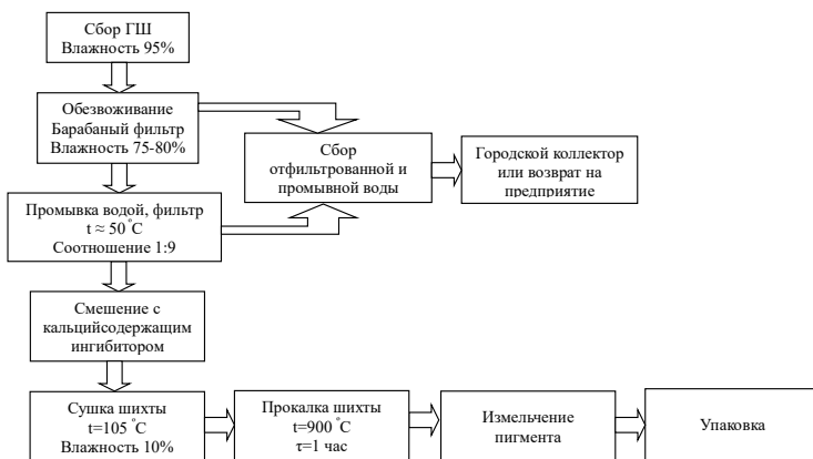
Рис. 1. Блок-схема приготовления антикоррозионного пигмента
