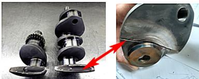
Рис. 2. Разрушения коленчатого вала между шатунными шейками
