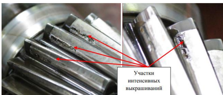
Рис. 2. Шестерня с выкрашиванием металла по профилю зуба [2]
