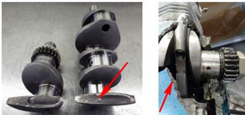
Рис. 2. Разрушение коленчатого вала и корпуса двигателя
