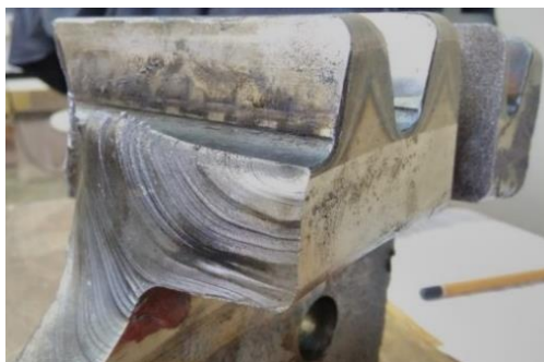
Рис. 1. Усталостный излом зубчатого колеса
