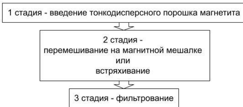
Рис. 2. Схема очистки сточных вод от ионов тяжелых металлов с помощью магнетита
