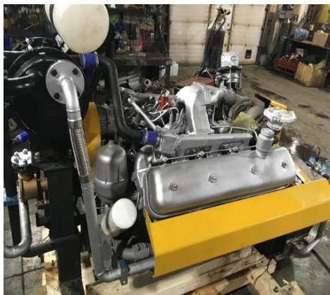
Рис. 2. Подготовка конвертированного двигателя к испытаниям (фото автора)
