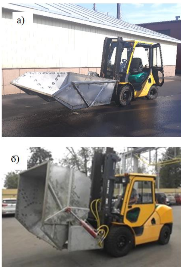
Рис. 1. Опрокидывающиеся емкости вилочного погрузчика: контейнер: для соли (а) и для транспортировки отходов (б)
