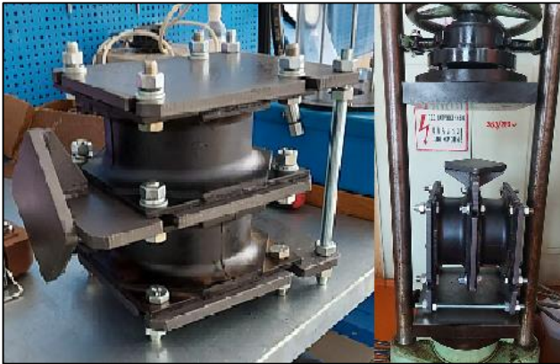
Рис. 2. Конструкция для экспериментальных исследований амортизаторов
