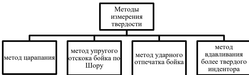
Рис. 2. Методы измерения твердости
