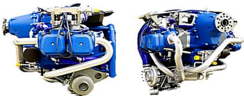
Рис. 1. Авиационный поршневой двигатель АПД 110/120
