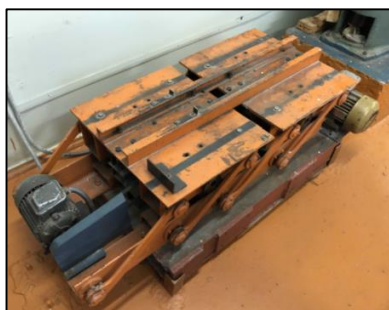
Рис. 2. Экспериментальный стенд виброударной виброплощадки
