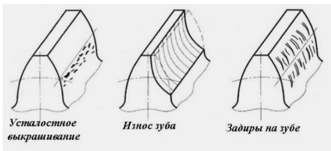
Рис. 1. Дефекты зубчатого колеса
