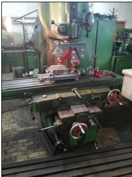
Рис. 1. Общий вид стенда для исследования процессов резания и динамического разрушения дорожно-строительных материалов
