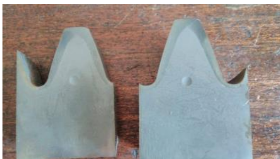
Рис. 2. Дефект отпуска закаленного слоя
