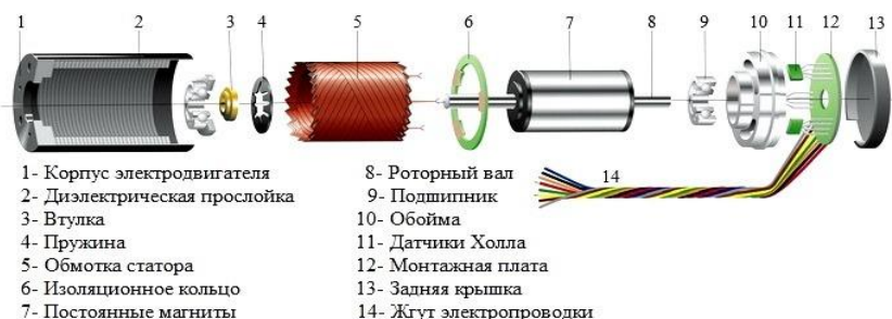
Рис. 1. Устройство вентильного двигателя
